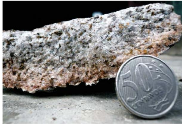
2.8. Estágio inicial de alteração de granito, caracterizado por zona de cor marrom-alaranjada, na parte externa de uma amostra-de-mão.
